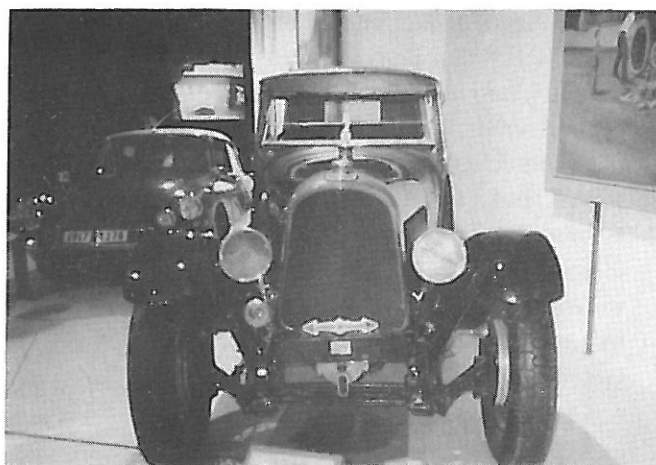
Voisin Le Corbusier 1929 model er som navnet antyder av fransk opprinnelse. Den er utstyrt med en sleidemotor med et volum på 1500 ccm som utviklet 44 hk v/4000 rpm. Sjekk retningsviserene i grillen.
