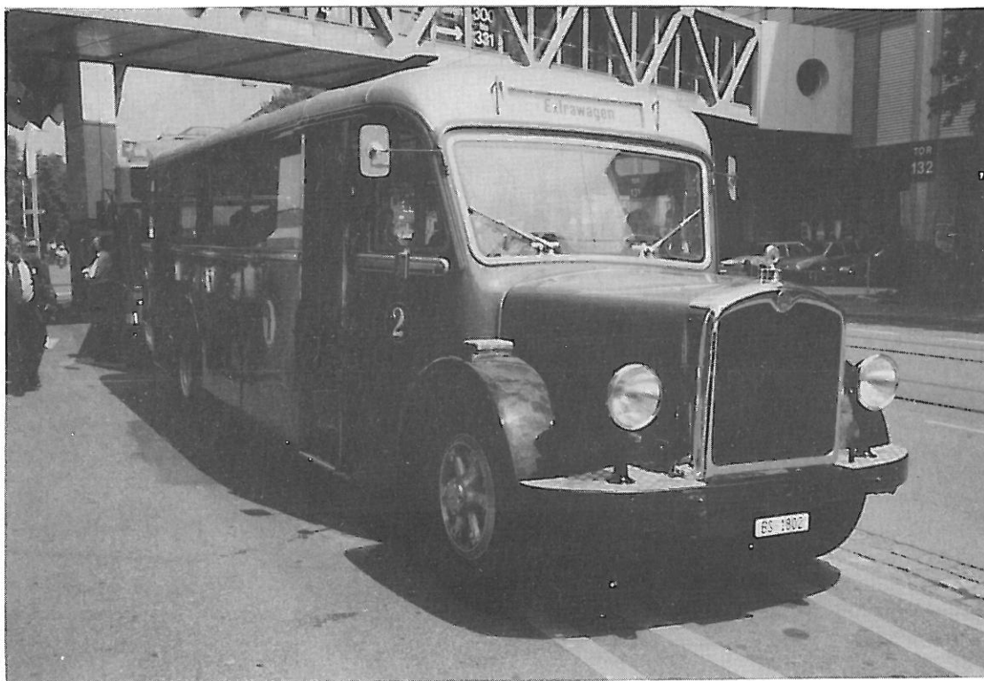
Saurer buss fra 1930. Den tilhører det kommunale sporveisselskapet i Basel, og jeg fikk gleden av å kjøre med den i juni. Den hadde opprinnelig bensinmotor og kjørte med generator under krigen. I 1946 ble bussen utstyrt med dieselmotor. Trilæxfelger er en selvfølge!
