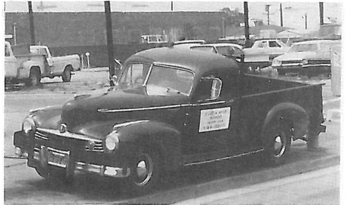
1946 Hudson pickup som servicebil. Frontfangeren er bygget opp med en solid stålplate for å kunne dytte kundebilene hjem til verkstedet.
