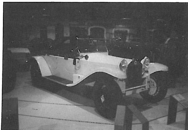
Lancia Lambda fra 1925, 2120 ccm. Vi kjenner igjen forstillingen som ble oppfunnet av en munk og fortsatt brukes av Morgan i dag.
