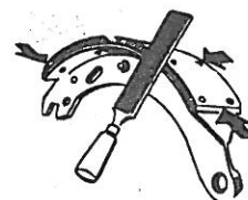
Puss av kantene med en fil.
