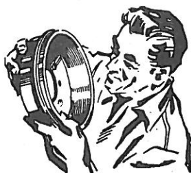
Undersøk om trommel er oppriperet avpusses med smergel evt. avdreies
