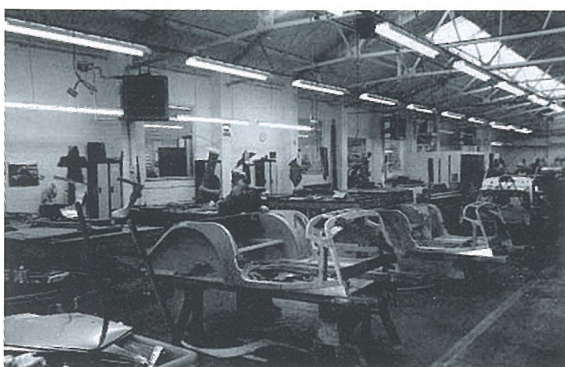
Karosseriet bygges av ask og kles med aluminium. Alt bankes på stedet.
