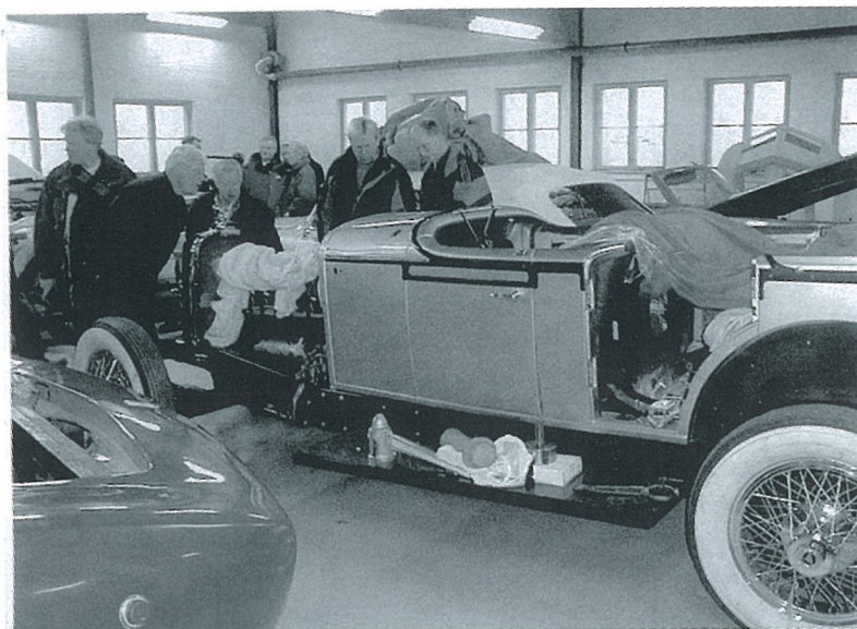
1928 Stutz Phaeton, 8 sylindret motor med overliggende kamaksel og dobbelt tenningsanlegg. Dette kommer til å bli en nydelig bil på veien.
