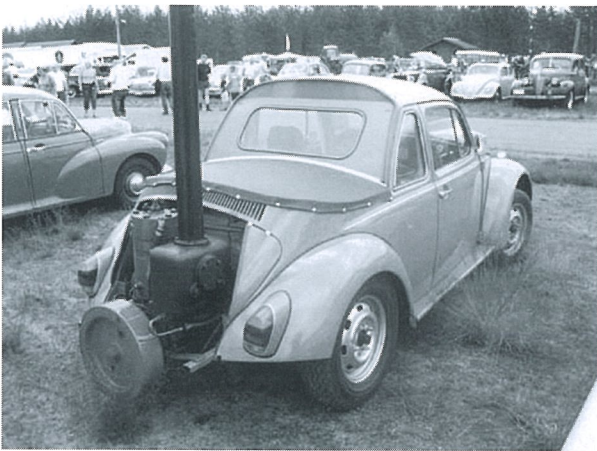
Ombygd VW med stasjonærmotor. Originalt
